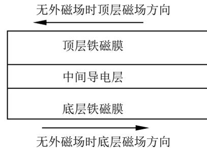
图 1 GMR 的多层膜结构
